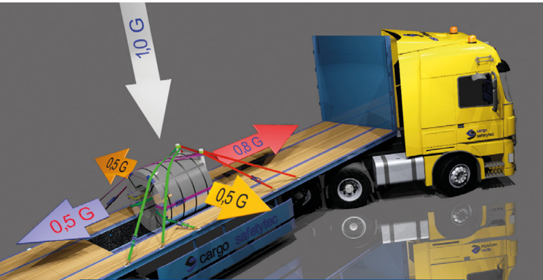
Abbildung 2: Notwendige Sicherungskräfte in Vielfachen der Gewichtskraft (Grafik: Ing. Bernhard Grabner, Cargo Safetytec)
