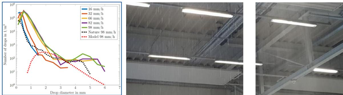
Abbildung 16: Parameter der Indoor-Regenanlage in der CARISSMA-Testhalle. Anmerkung: Abbildung links – einstellbare Regenintensitäten (16-98 mm/h) mit Tröpfchenverteilung im Vergleich zum natürlichen Regen mit 98 mm/h. Abbildung rechts: Zur Verbesserung der Tröpfchenverteilung sind unter den Regendüsen mehrere Netze gespannt, die kleinere Tröpfchen sammeln und als größere Tröpfchen abregnen lassen. (Quelle: CARISSMA)
