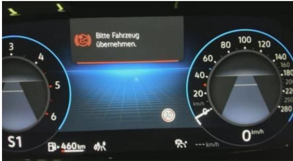
Abbildung 20: Fahrzeug nach Auslösung AEB, Bremsung und Warnung. (Quelle: CARISSMA)
