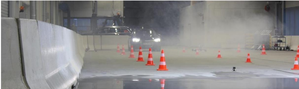
Abbildung 15: CARISSMA-Innenanlage während eines Fahrversuchs. Anmerkung: Im Vordergrund ist die regennasse Fahrbahn zu sehen. Ebenfalls zu erkennen ist die beginnende Vernebelung der Halle durch die Nebelanlage (Wasserpartikel). (Quelle: CARISSMA)
