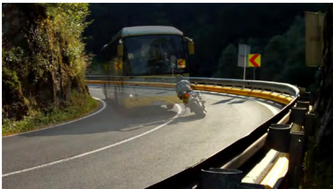
Abbildung 46: Fahrlinien von Motorrädern in engen, unübersichtlichen Linkskurven
