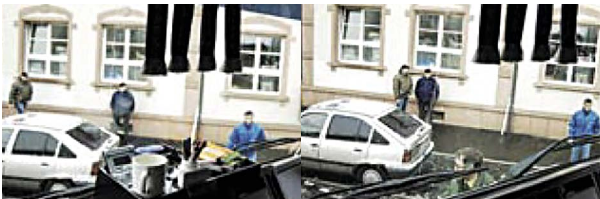
ABBILDUNG 83: Beispiel für Sichtbehinderungen durch Innendekoration im Führerhaus: Sicht mit Innendekoration (links) und Sicht ohne Innendekoration (rechts; vgl. DVR 2005)
