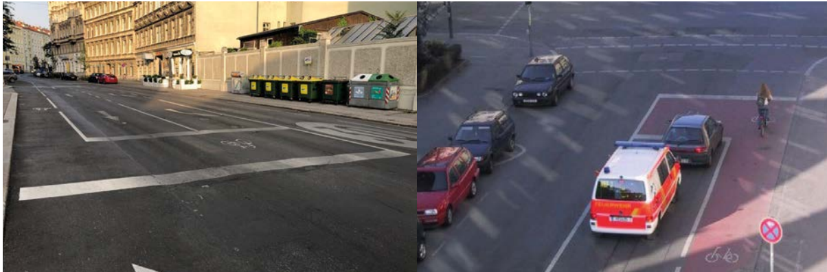
ABBILDUNG 38: Beispiele für eine vorgezogene Haltelinie mit Aufweitung der Aufstellzone („Bike Box“), ohne und mit Einfärbung: Wien (links; Foto: KfV) und Hannover (rechts; Quelle: Horn et al. 2015: 33)
