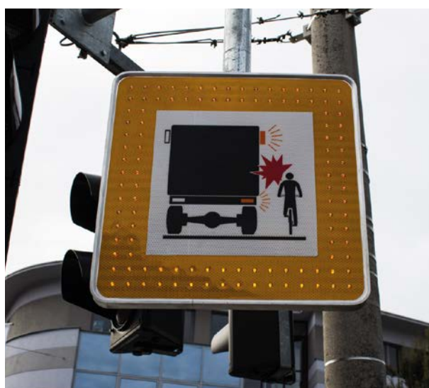
ABBILDUNG 54: Aktivierte LED-Warntafel in Salzburg (Foto: KfV)
