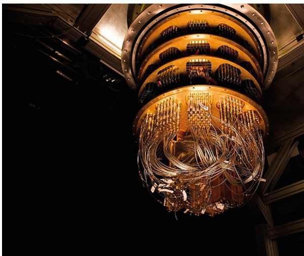
ABBILDUNG 6: In diesem Kabelsalat wird der Chip bis auf den absoluten Temperatur-Nullpunkt gekühlt, Quelle: google
